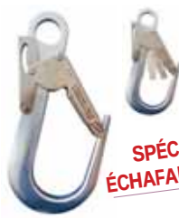
3805D aluminium à verrouillage automatique ouverture 60mm 240 x 130mm, 430 gr. Résistance 22kN (2243kg)
